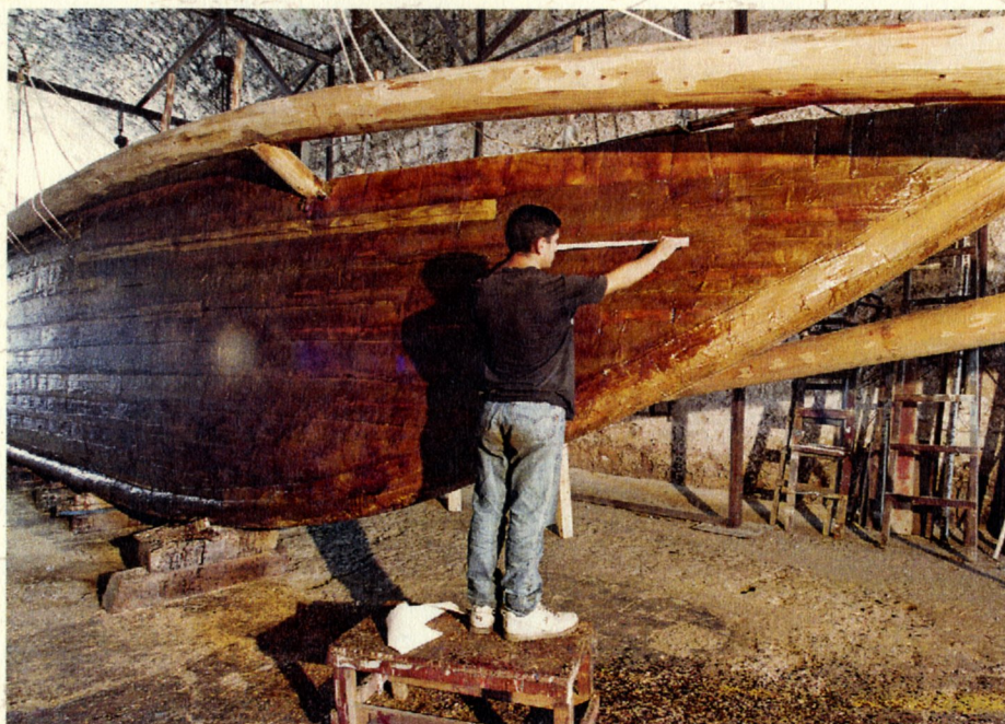
Επάλειψη του περιβλήματος με το μείγμα στεγανοποίησης
