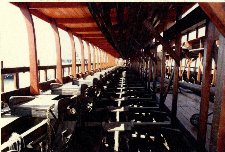
Ανακατασκευή της Τριήρους Ολυμπιάς στα Ναυπηγεία Ελευσίνος
