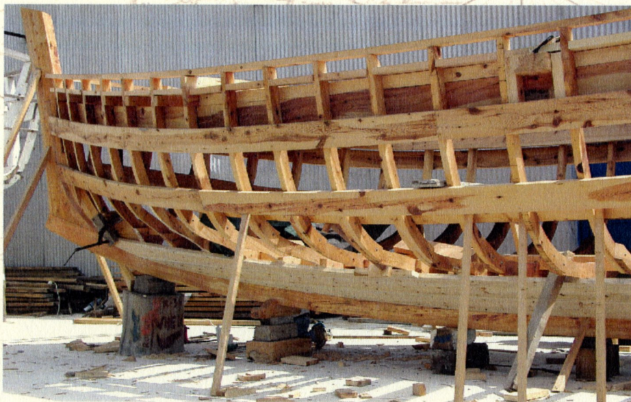
Από τα πρώτα στάδια της κατασκευής του Κερύνεια Ελευθερία
